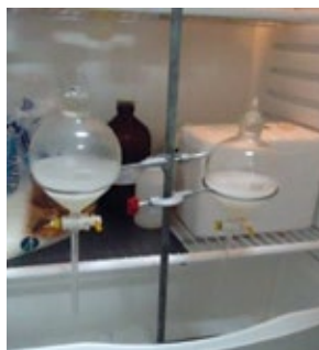
Figura 7 – Filtrado antes (a) e após 2 h sob refrigeração (b), para a obtenção de duas fases.
