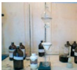
Figura 8 – Aparato para a filtração da parte orgânica.
