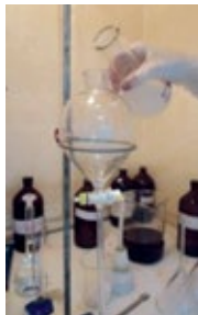
Figura 5 – Transferência da amostra filtrada para o balão de destilação.
