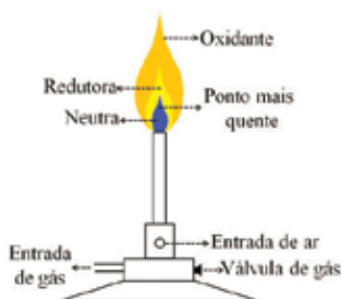
Figura 10 - Representação das chamas no bico de Bunsen.
