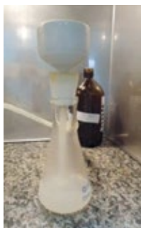
Figura 4 – Sistema para filtração com funil de Büchner e Kitassato.
