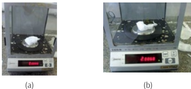
Figura 2 – Pesagem da amostra: (a) bag de nylon na balança já tarada e (b) amostra pesada.
