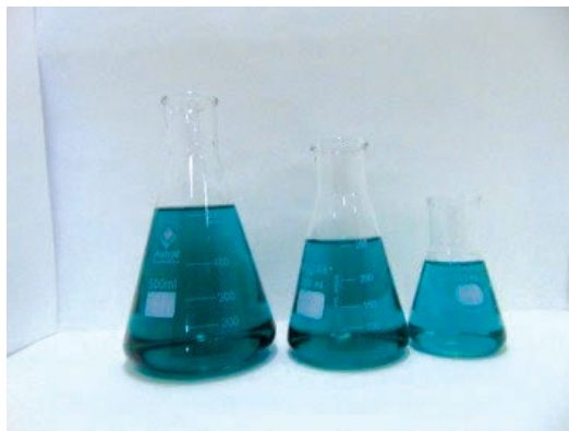
Figura 6 – Erlenmeyer de diferentes capacidades (as soluções contidas nos recipientes são apenas para facilitar a visualização da vidraria).
