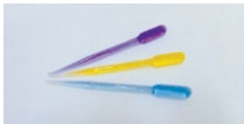
Figura 40 – Pipetador plástico de Pasteur (as soluções contidas nos pipetadores são apenas para facilitar a visualização dos mesmos).
