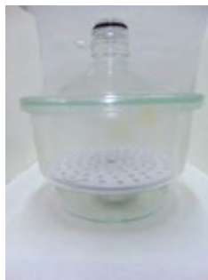
Figura 20 – Conjunto de dessecador e tampa de vidro, e base de cerâmica na parte interna.
