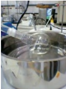
Figura 10 – Colocação do balão de fundo redondo no evaporador rotativo a vácuo: (a) acoplamento e (b) conexão das mangueiras para circulação de água.
