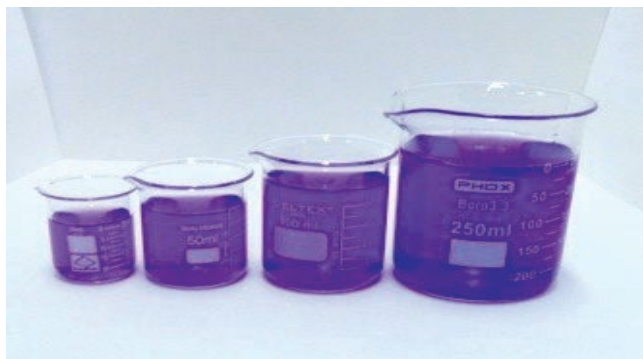
Figura 5 – Recipientes de bquer de diversos volumes (as soluções contidas nos recipientes são apenas para facilitar a visualização da vidraria).
