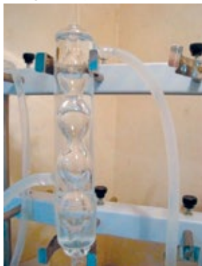
Figura 18 – Conexão de mangueiras para a circulação de água no condensador.
