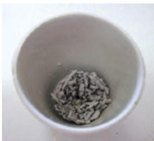
Figura 3 – Coloração de amostra após incineração em mufla para a determinação de cinzas.
