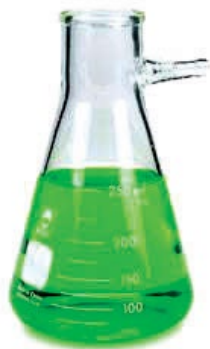
Figura 7 – Kitassato (a solução contida no recipiente é apenas para facilitar a visualização da vidraria).
