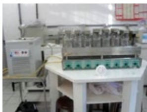
Figura 6 – Equipamento montado para realização das digestões ácida e alcalina.
