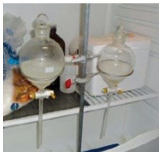
Figura 7 – Filtrado antes (a) e após 2 h sob refrigeração (b), para a obtenção de duas fases.
