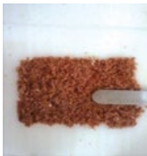
Figura 3 – Etapas do quarteamento manual de uma amostra sólida: (a) espalhamento da amostra em papel filtro, formando um quadrado/retângulo, (b) separação em quatro partes em forma de cruz, e (c) devolução de dois segmentos para o pacote.
