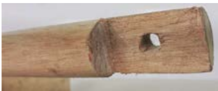
Figura 5 – Furo com broca 10 mm.
