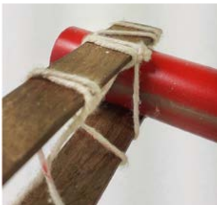
Figura 15 – Tubos amarrados em uma das partes da madeira.
