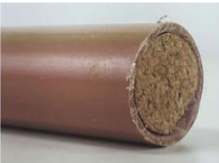
Figura 18 – Engate da rolha no tubo.
