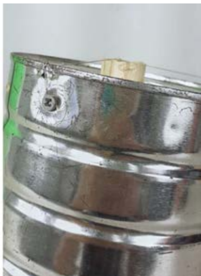
Figura 8 – Fixação da corda de violão na lata.
