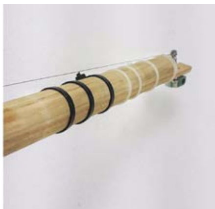
Figura 10 – Presilhas de plástico afixadas no braço da viola.
