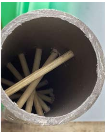
Figura 32 – Palitos inseridos ao longo da espiral no interior do tubo.
