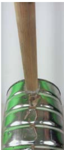
Figura 7 – Encaixe do cabo de madeira no furo da lata.
