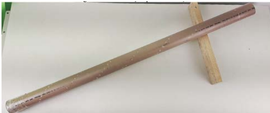
Figura 31 – Marcação para as furações.
