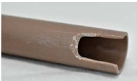
Figura 22 – Corte no tubo de PVC lixado.
